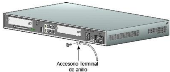
Conexión a tierra del router
