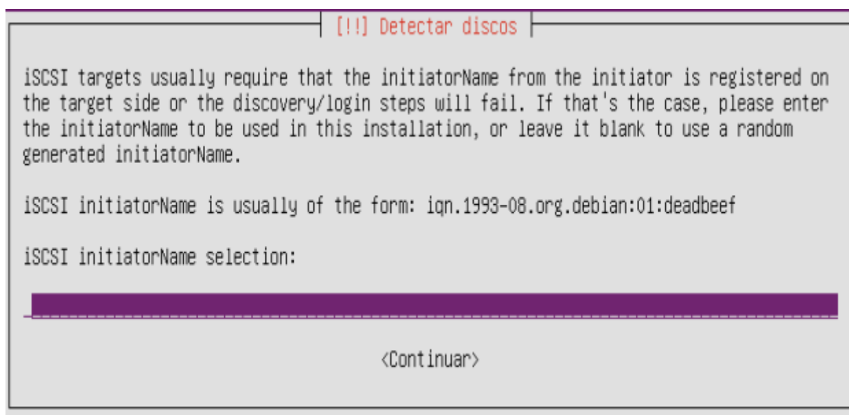
Figura 5.27. Instalación Ubuntu: nombre del iSCSI Initiator
