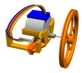
Cabe destacar en este caso que la rueda no entra con soltura en la clavija del motor y es necesario o modificar el código de la pieza en 3D o limar por dentro un poco para poder encajar las dos piezas.
