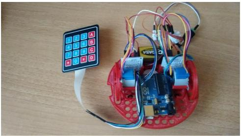
Finalmente para dar energía a la placa y los motores se ha optado por una pila de 9v. Se ha realizado un pequeño corte en la parte trasera del casco o "protector" para poder extraer el keypad y además como no estaba enfocado a esta placa era necesario ya que por volumen el cable de corriente del Arduino hacia la batería no cabía.
