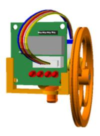
Para unir la pieza que contiene el motor y su soporte con la base , he utilizado bridas puesto que las piezas que se ha imprimido para unir las dos partes son demasiado duras y da la sensación de poder romperse.
