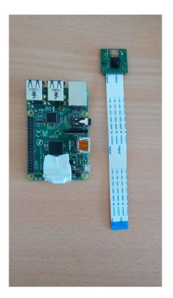
Después introduciremos el conector Sunny de la cámara en la clavija con el plástico azul del final del conector mirando en dirección al conector RJ-45.
