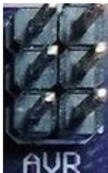
Por último, la placa necesita 5V para su alimentación, para eso hay que conectar el cabezal de 5V de la Raspberry con el cabezal de alimentación de la placa, este es el que está en el extremo inferior izquierdo del panel AVR de la placa.
