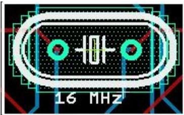
El oscilador de cristal es el componente que proporciona la frecuencia del reloj.
