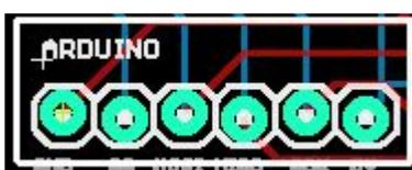
A pesar de estar señalado como **Arduino** estas conexiones serán las que sirvan para conectar la placa al convertidor de nivel lógico bidireccional, que hará de puente de la conexión con la Raspberry por motivos que se explicarán más adelante.
