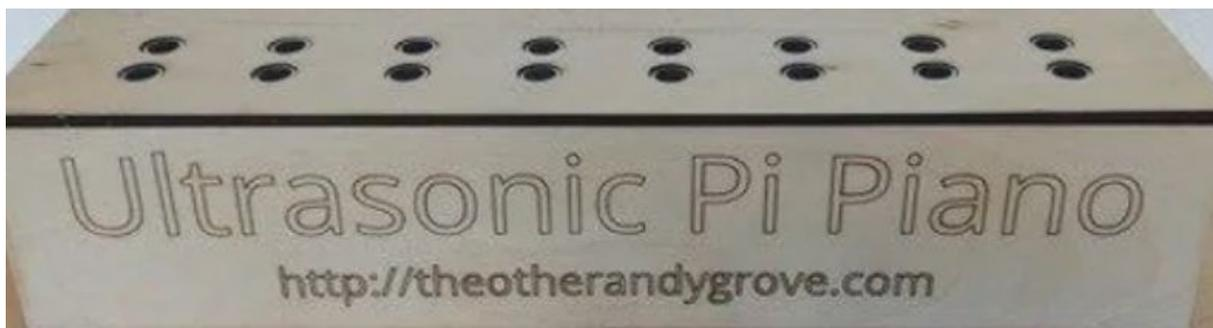
Sin embargo para evitar las interferencias se decidió crear una carcasa de ochenta centímetros, pudiendo así dejar un espacio entre cada sensor lo suficientemente amplio para que colocar una mano encima no interfiriera con los que tenga a los lados.
