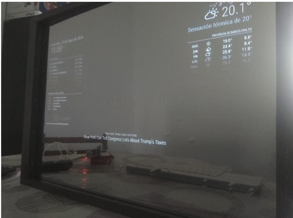
6.- El último paso es colocar el Raspberry en la parte posterior del monitor, con tornillos o pegamento de contacto, y conectarlo con todos los cables. Colócalo en la pared con un gancho, con silicona o de la forma que más cómoda te sea.
