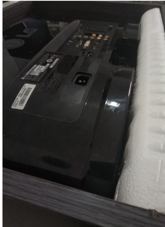
A continuación implementamos la sujeción final para que el monitor no se desprenda ni tambalee al colocarlo en posición vertical. Colocamos una tabla de madera cortada con las medidas del hueco posterior, ejerciendo una leve presión para mantenerlo todo bien sujeto. Procedemos a atornillar.
