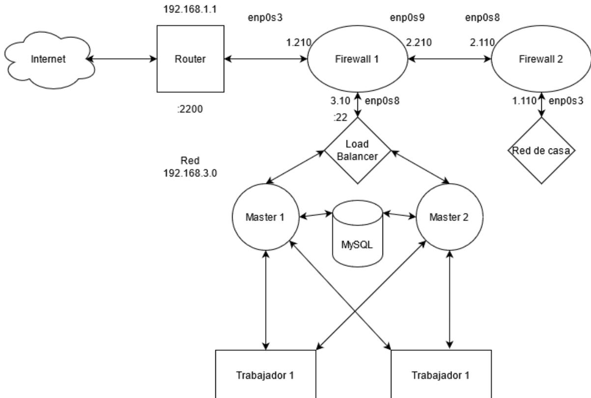
Pero en nuestro proyecto por falta de máquinas físicas no podemos realizar este esquema físicamente con las raspberry pi ya que no podemos crear tantas redes. Al tener dos máquinas físicas con una máquina virtual en cada una con adaptador puente, al poner una red distinta a la anfitriona, por ejemplo 192.168.3.0. Se pueden ver entre ellas, pero ocurren errores de red. Como por ejemplo paquetes duplicados,
