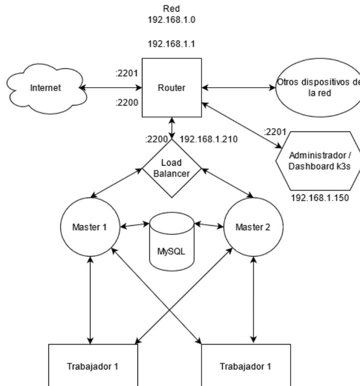
Se puede seguir accediendo al balanceador de cargas desde el exterior de la red mediante SSH conectando con el router, pero sin un intermediario, el firewall 1. Además en este esquema implementamos el dashboard de k3s al que podemos acceder por el puerto :2201 vía ssh.
