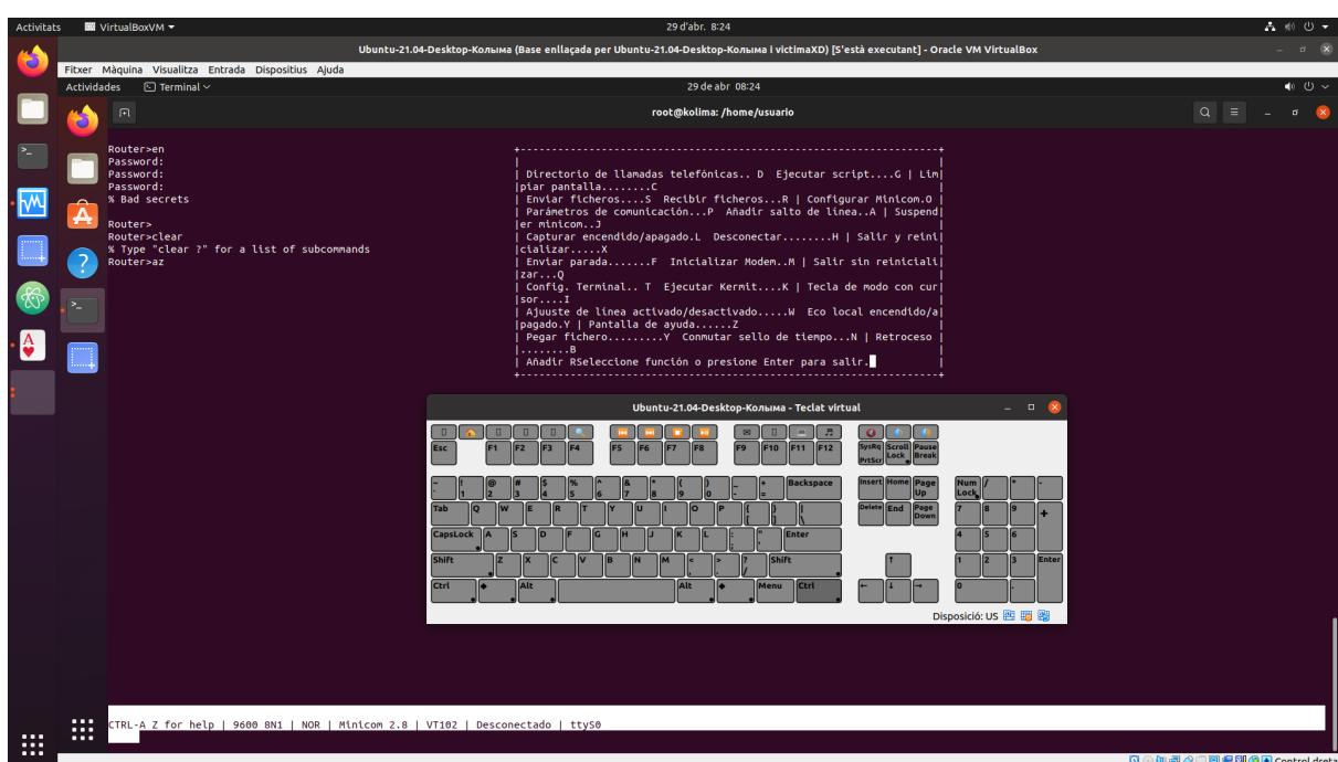
Después de tener las opciones en pantalla, apagamos el router y lo encendemos entonces pulsamos F, de esa forma entraremos en el modo rommon. Al entrar en el modo rommon, entonces se escribe el siguiente comando.
