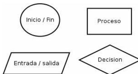
El inicio o el final del programa se indica dentro de un círculo. Los procesos internos, como realizar operaciones, se encuadran en un rectángulo. Las entradas y salidas (escrituras en pantalla y lecturas de teclado) se indican con un paralelogramo que tenga sus lados superior e inferior horizontales, pero no tenga verticales los otros dos. Las decisiones se indican dentro de un rombo.
