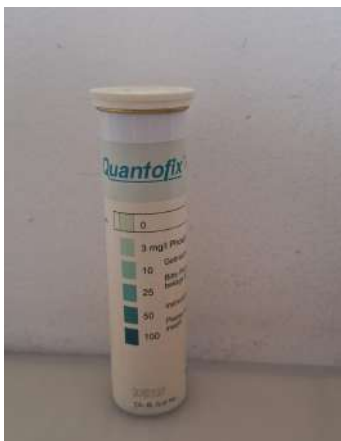
Imatge 72. Fotografia de les tires reactives de fosfat. Font pròpia
