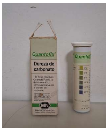
Imatge 71. Fotografia de les tires reactives de Carbonat. Font pròpia
