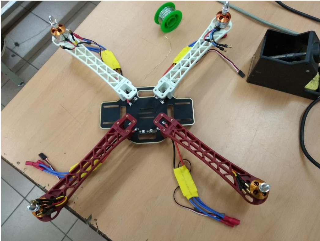
Imatge 28: Estructura del dro amb els motors. Imatge pròpia
