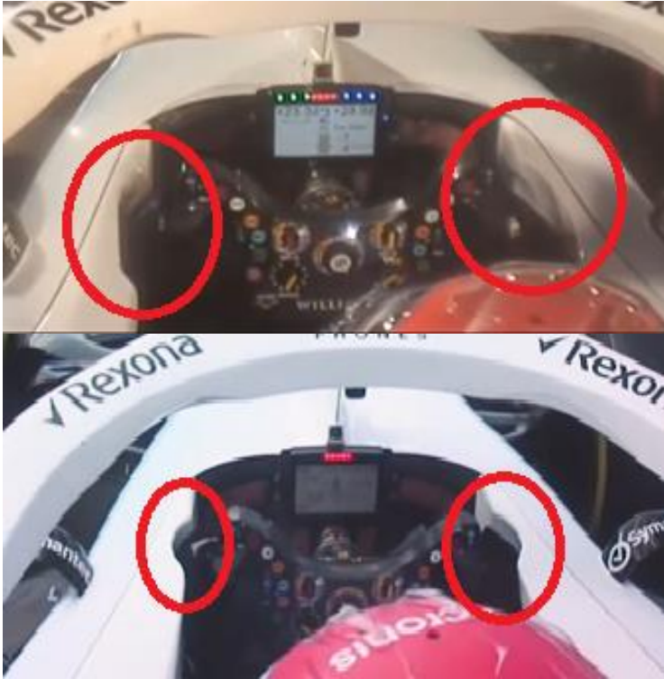
Imatges 93 i 94. Diferència de mida entre els forats del cockpit de Kubica (imatge superior) i els de Russell (part inferior).
