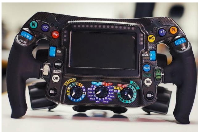
Imatge 76. Volant de l'equip Mercedes, un dels més senzills de la graella. https://www.youtube.com/watch?v=OX58IkeSI4c
