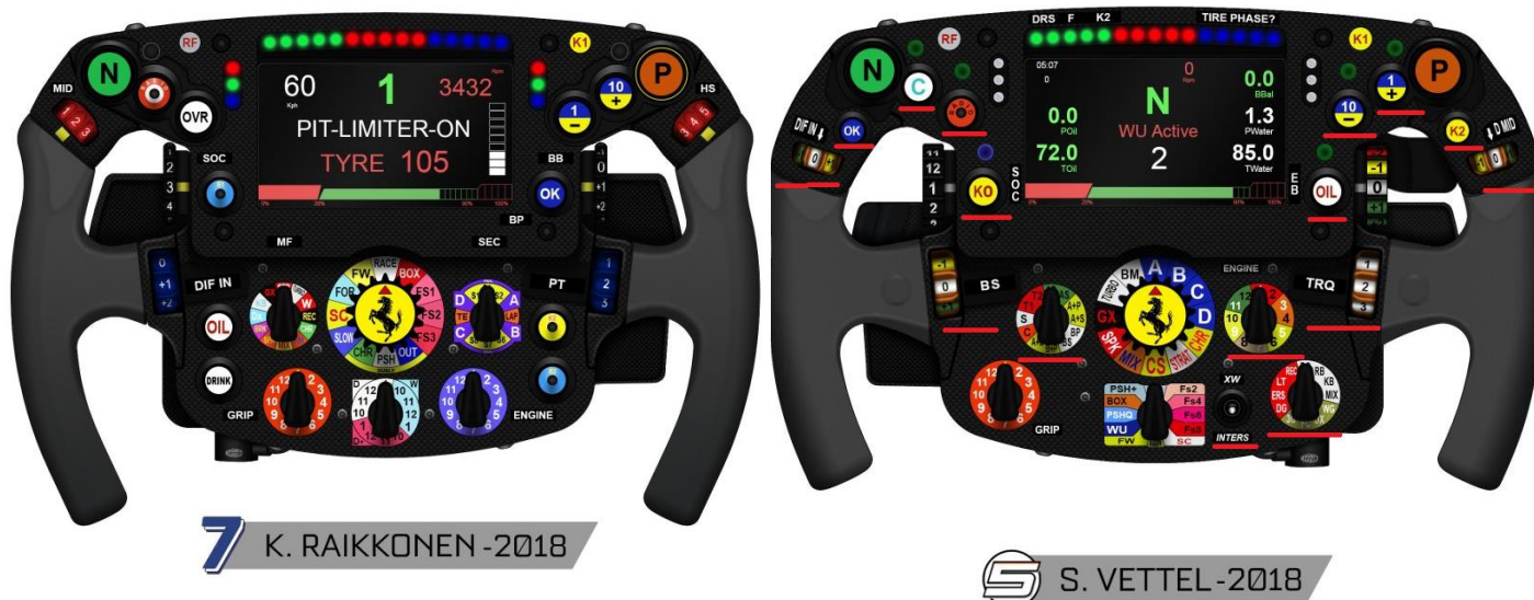
Imatge 80. Volant dels pilots de Ferrari l'any 2018. Al volant de Vettel es poden veure subratllades les funcions diferents a les del seu company Raikkonen. https://twitter.com/Gianludale27
