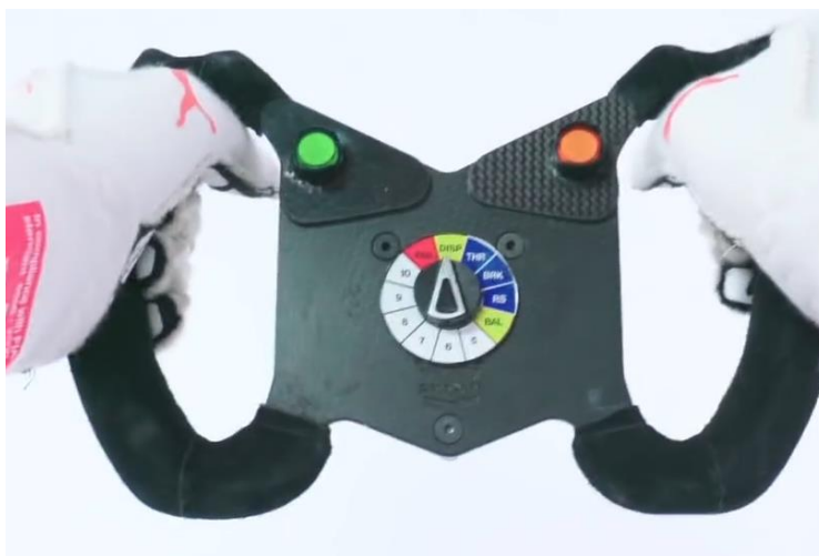
Imatge 60. Volant de Gerard Berger, de Ferrari, el 1989, amb una forma innovadora, dos botons i una de les primeres rodes giratòries. https://www.motor.es/formula-1/video-evolucion-volantes-f1-historia-201632330.html
