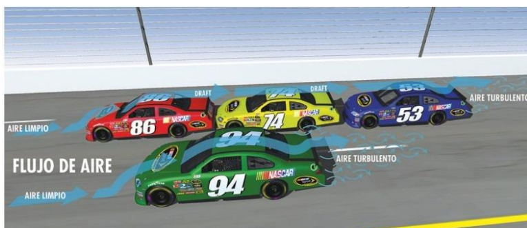
Imatge 39. Funcionament del rebuflament i de l'aire brut a la Nascar, categoria semblant a la F1. https://www.taringa.net/+autos_motos/aerodinamica-principios-basicos-1_hjswu
