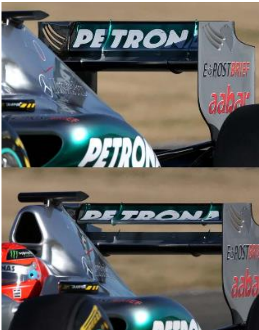
Imatge 42. Ala posterior del Mercedes. Es pot observar un endplate i l'activació del DRS en la imatge inferior.
