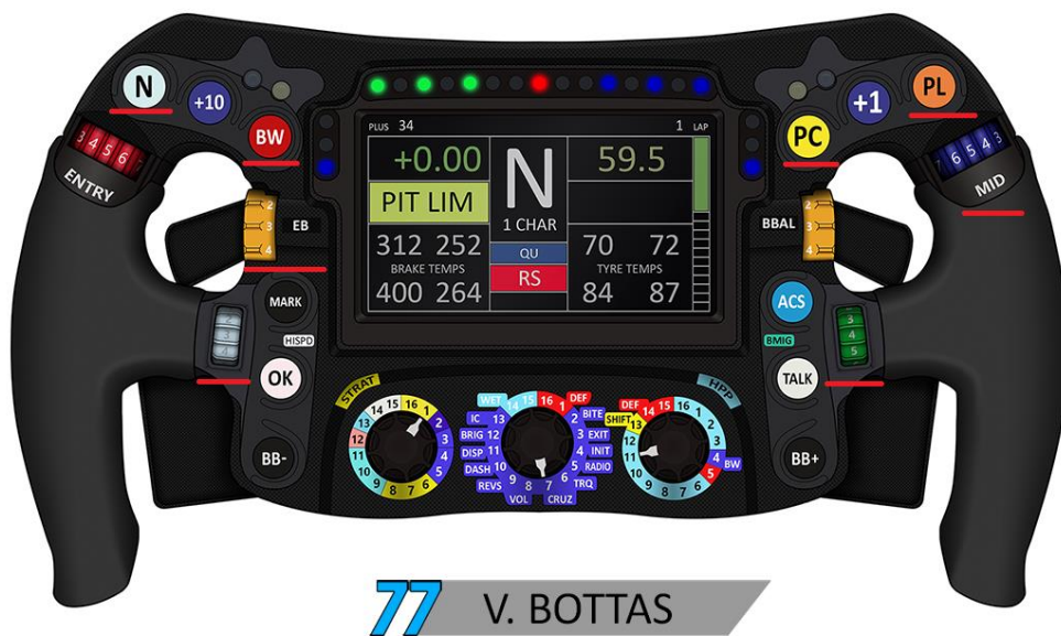
Imatge 78. Volant de Valtteri Bottas, amb els botons diferents respecte a Hamilton subratllats. https://f1grandprix.motorionline.com/f1-tecnica-in-pillole-il-volante-di-lewis-hamilton/
