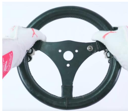
Imatge 59. Volant de James Hunt el 1978, el primer a incorporar un interruptor electrònic. https://www.motor.es/formula-1/video-evolucion-volantes-f1-historia-201632330.html
