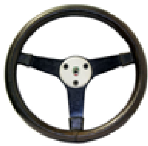
Imatge 58. Volant de Bruce McLaren de l'any 1969. Fet per metall i folrat de cuir, la seva única funció era la de dirigir el monoplaça. https://autoproyecto.com/2019/noticias/evolucion-volantes-mclaren-formula-1.html/2
