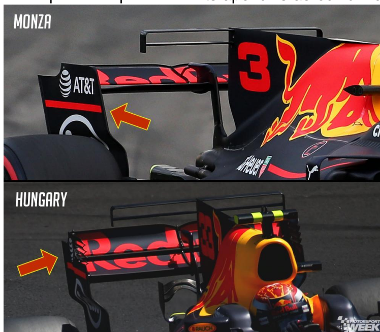
Imatge 38. Diferència de l'angle d'atac de l'ala posterior segons la configuració aerodinàmica relacionada amb el circuit. https://www.motorsportweek.com/news/id/15846
