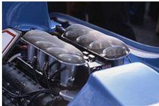
Imatge 46. Motor Ford-Cosworth V8 en un Ligier de 1979. https://en.wikipedia.org/wiki/Cosworth_DFV
