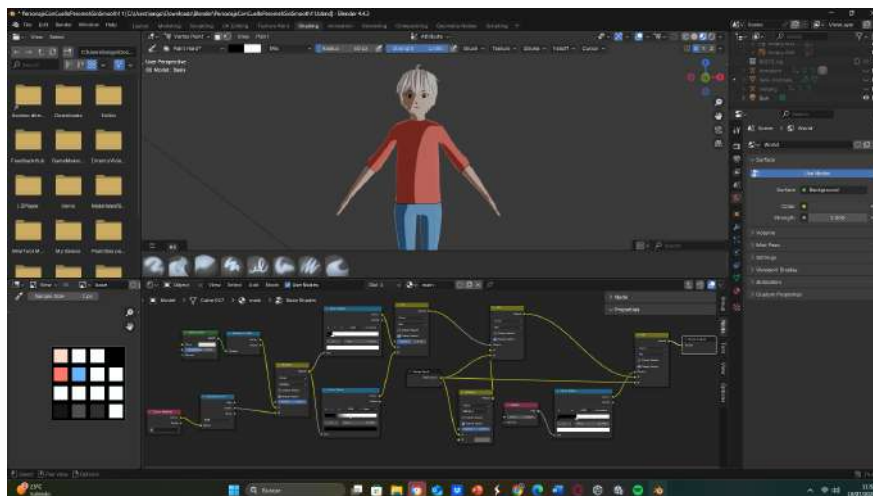
Imatge 83. Creació del shader a través de nodes. Font pròpia
